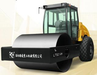
采用国外先进技术及进口关键零部件生产的全液压振动压路机。该机属超重型振动压路机,具有较大的工作质量和强大的激振力,因而是大面积、高质量、高效能、机械化施工中的最佳压实设备。它适宜于碾压非粘性材料,如砾石、碎石、沙石混合料、砂性土壤等对低料性材料也有良好的压实效果;本机是高速公路、矿山道路、大型堤坝、重要港口及工业场地等工程中的基础压实的理想设备。
