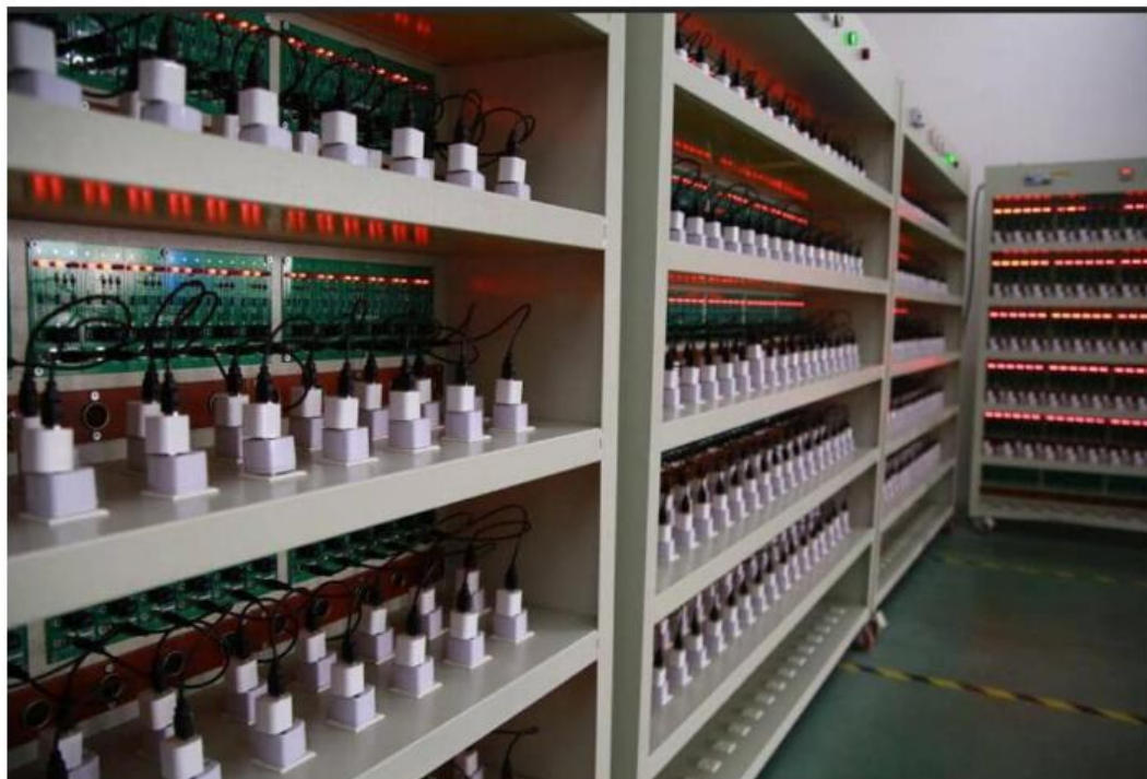
Control de calidad, cada cargador prueba uno por uno después de producir
