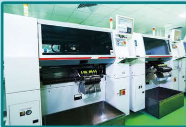
▲ 三星贴片机 SAMSUNG SMT machine
