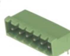
X977211 3.81mm Female terminal block (right angle) A: 2P B: 3P C: 4P D:5P E: 6P F: 7P G: 8P H:9P J:10P K:11P L:12P
